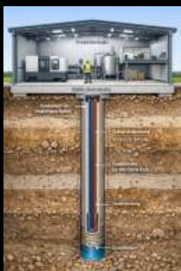
Erdsodenbohrung unter Anbau
